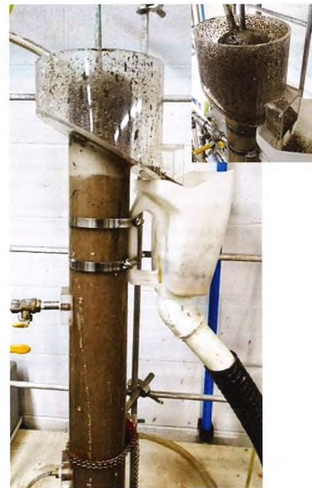
Рис. 2. Флотация шламов в колонной машине
