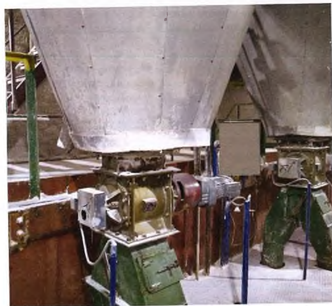
Рис. 2. Разгрузка циклонной пыли из циклонов сухой пылеочистки в гидрожелоба в сушильном отделении БКПРУ-4
