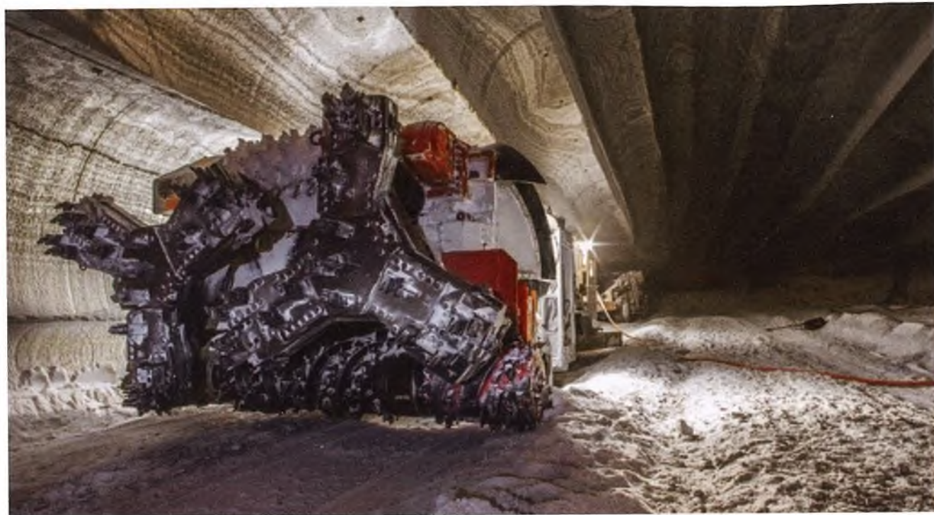
Рис. 1. Комбайн Marietta-900 в камере для добычи каменной соли
